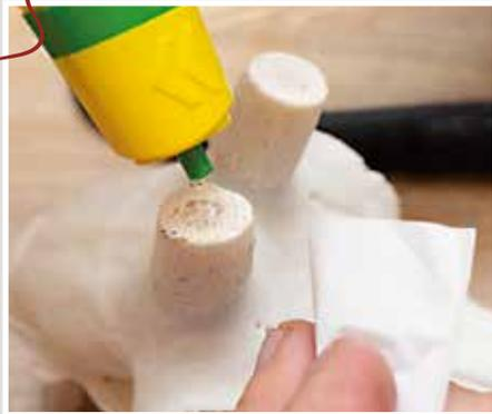
Die Kappstelle der Stirnzapfen wird mit einigen Tropfen Klebstoff benetzt.
