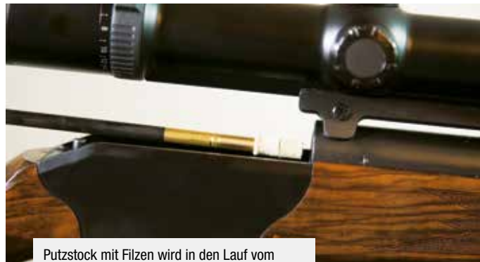
Putzstock mit Filzen wird in den Lauf vom Patronenlager Richtung Mündung eingeführt.
