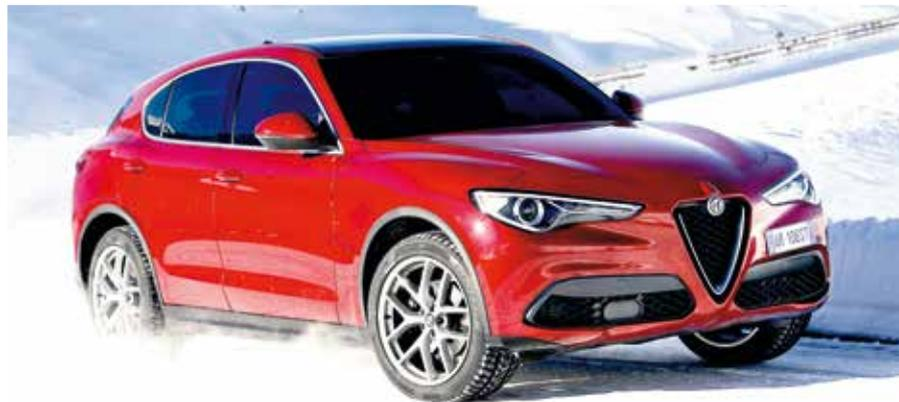
Unter normalen Bedingungen verhält sich der Stelvio wie ein Hinterradler, das 4-System schickt die Kraft zu 100 Prozent auf die Hinterachse. Ändern Schlupf oder schwieriger Untergrund die Bedingungen, schaltet das SUV umgehend auf Allradantrieb und überträgt 50 Prozent der Kraft auf die Vorderachse.
